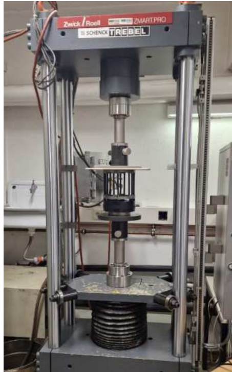
Abbildung 4.3: Testaufbau der Komponenten in der hydraulischen Prüfmaschine. 1
