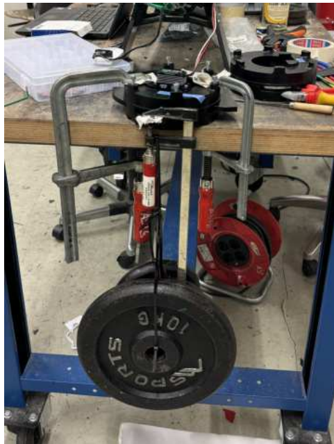
(a) 17 kg Gewichte, um ca. 170 N zu simulieren.
