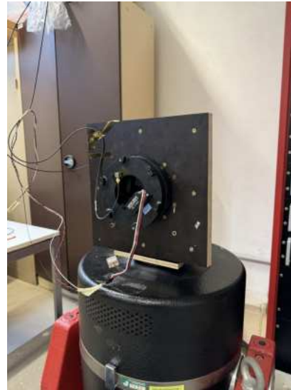
(a) Horizontaler Aufbau für Test Nr. 1 und Nr. 2 (b) Vertikaler Aufbau für Test Nr. 3 und Nr. 4
